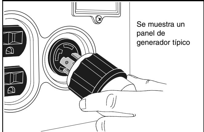
Figura 36 — Alineación de los conectores en el generador
